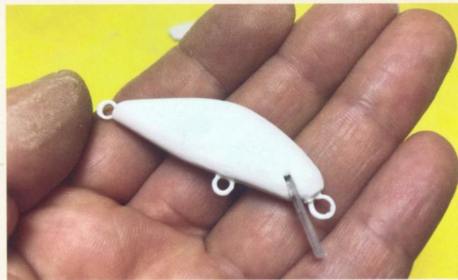
me da ferro e carta abrasiva, esegui-remo in fine il taglio nel quale passerà l'armatura.
